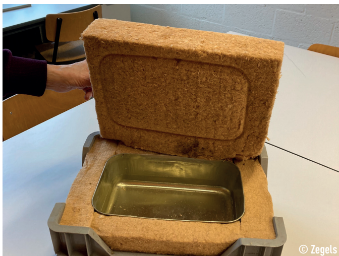
Figure 23 : Exemple de bac isolé à l'aide d'un isolant en fibres de bois pour le refroidissement de la cire et la décantation des impuretés.
