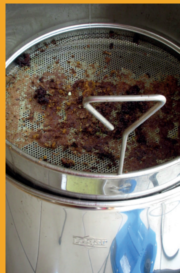
Figure 21 : Panier de récupération des impuretés après fonte des cadres.
