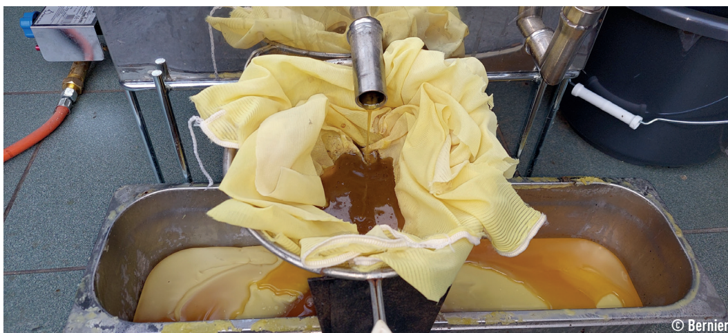
Figure 22 : Filtration de la cire à la sortie du cérificateur.
