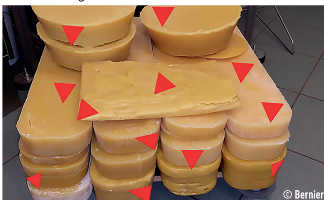
Figure 9 : Prélèvements à différents endroits du bloc lors de l'échantillonnage d'un bloc de cire.
