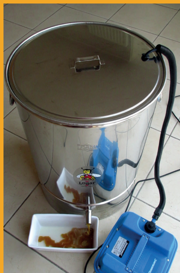
Figure 19 : Cérificateur en cours de fonctionnement.
