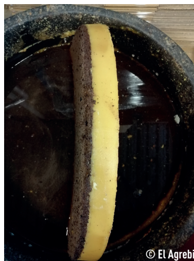
Figure 24 : Fond de cuve avec une séparation nette des « grosses » impuretés et de la cire.
